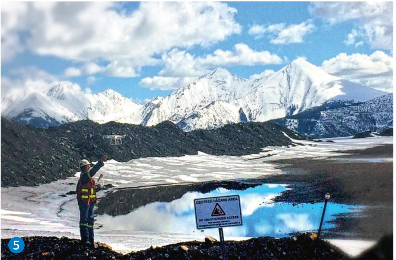
5. En las operaciones de Teck se utiliza drones para numerosas funciones, lo que incluye ayudar a monitorear el despeje de los gases de tronadura y llevar a cabo evaluaciones post tronadura, levantamientos fotogramétricos para volúmenes y diseño, y análisis geotécnico. En la foto: operación Greenhills.
